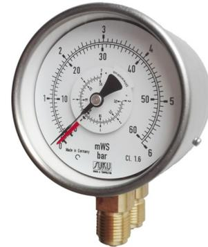
Differenzdruckmanometer mit 2 Rohrfedern sind preisgünstige Geräte zum Messen von zwei unterschiedlichen Drücken mit direkter Anzeige des Differenzdruckes. Der höchste im System auftretende Druck darf nicht höher sein als der Skalenendwert!
